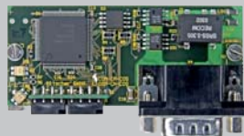
Les modules "COM" couvrent tous les protocoles bus de terrain et Ethernet dans un format très réduit.
